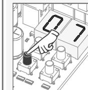
05 • Drücken Sie cmd 3 Sekunden lang. Die Position ist leer. Das Display blinkt und die Position wird verfügbar.
