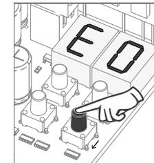
02 • E0 wird angezeigt. Drücken Sie UP, bis E7 angezeigt wird.
